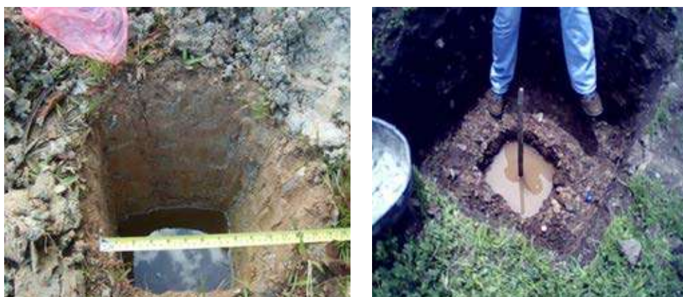
Ensayo del test de percolación
