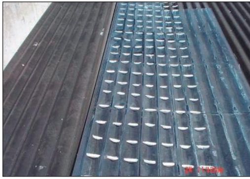
Prototipo con difusores de tecnopor espaciados cada 10 cm
